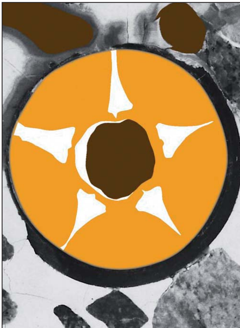
På genomskärningen av provstycket kan man se hur injekterings slangens fungerar. Den ljusgrå massan är mikro cement från förinjekteringen, den bruna massan epoxi som använts vid efterinjekteringen.
